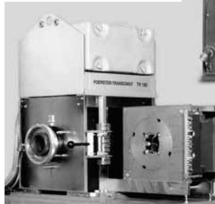
Fig. Detección de falla longitudinal con ROTOMAT.
